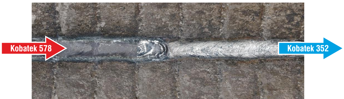
Resim-2 Kobatek 352 ile kaynaklı birleştirme üzerine Kobatek 578 ile sertdolgu uygulaması
