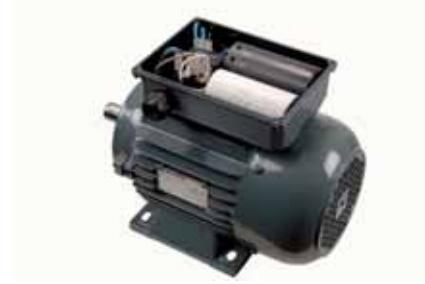
Kalkış+Daimi Kondansatörlü motorların ana ve yardımcı sargı uçları ile daimi devre kondansatörü ve daimi devre kondansatörüne paralel bağlı olan kalkış kondansatörünün uçları, elektronik kalkış rölesinin klemenslerine bağlanır ve besleme uçlarına gerilim verilmesi ile birlikte motor yüksek bir kalkış momenti ile yol almaya başlar.
